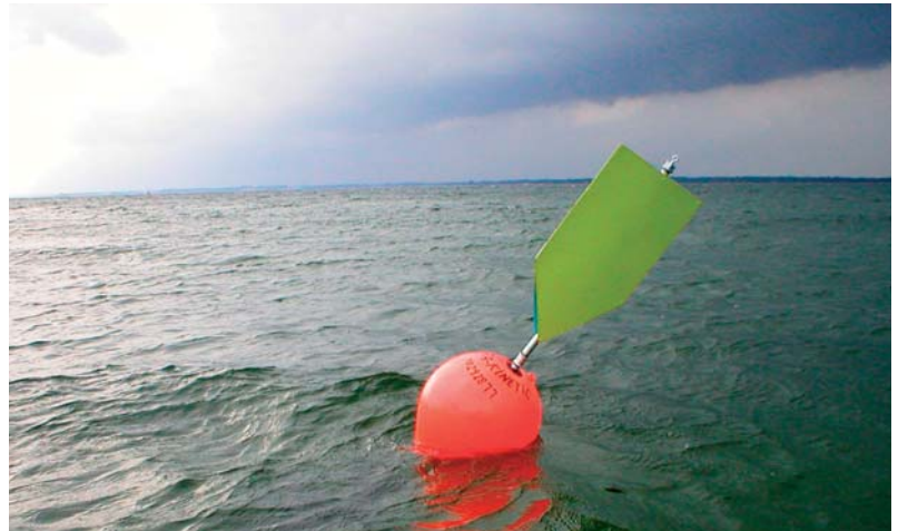
Bojen kan ange både strömmens hastighet och riktning
